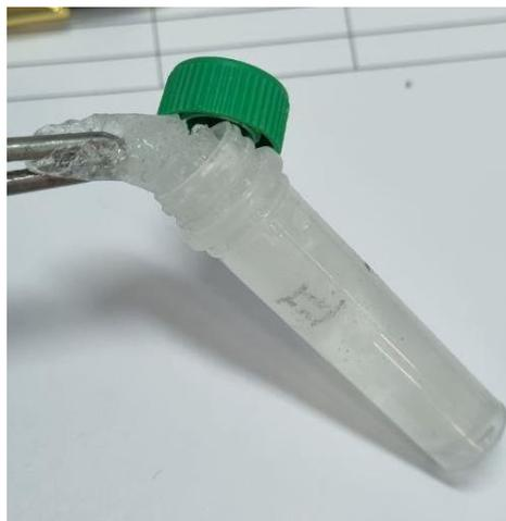
Рис. 7. Образец смеси БА, полученный при добавлении 0,1 масс. % инициатора при мощности 1080 Вт и частоте 20 кГц
