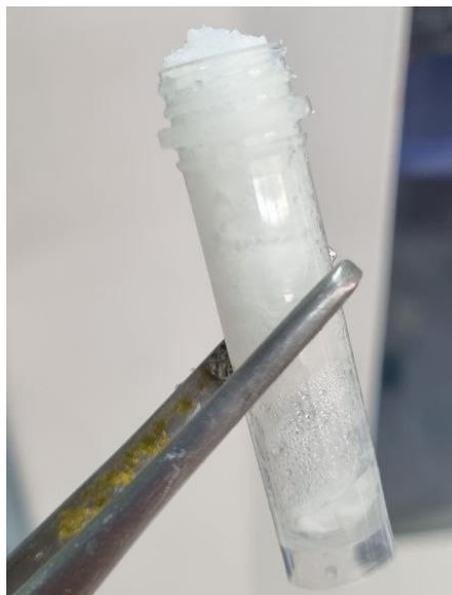
Рис. 8. Вид смеси БМ4 после полимеризации
